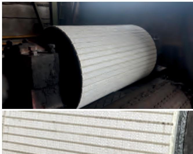
Плиточная керамическая футеровка приводного барабана
